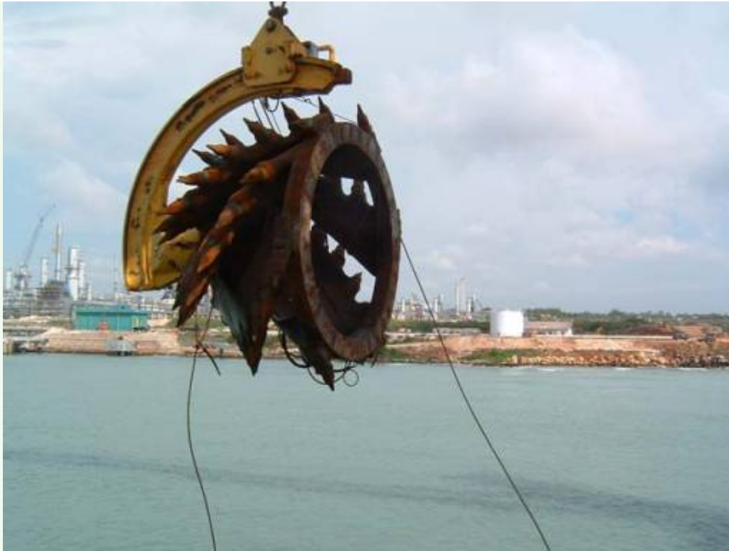
het hijsen van een cutter met speciaal hijsgereedschap
