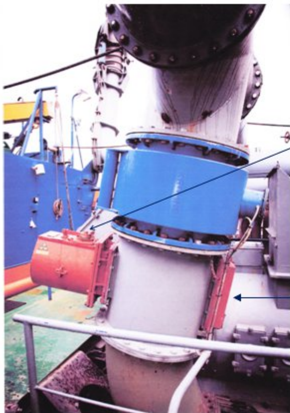
foto van een concentratiemeter gemonteerd in de persleiding van een sleepopper
