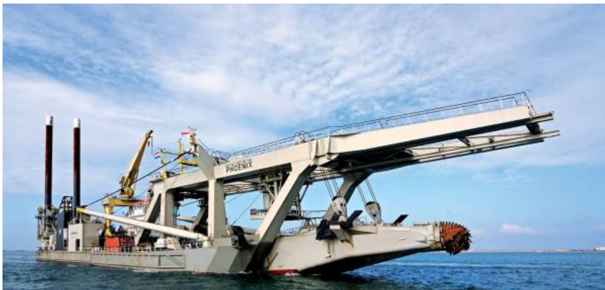
niet zelfvarende cutterzuiger
