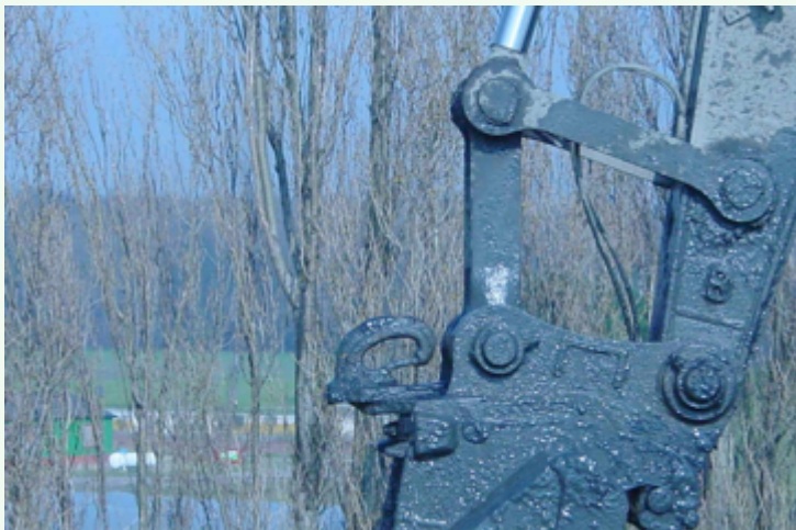
Foto 37 gekeurde hijshaak op het vaste deel van de giek.
