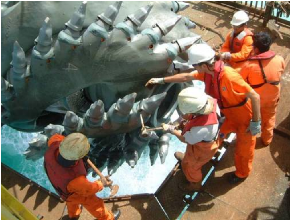
het wisselen van tanden op een cutterzuiger
