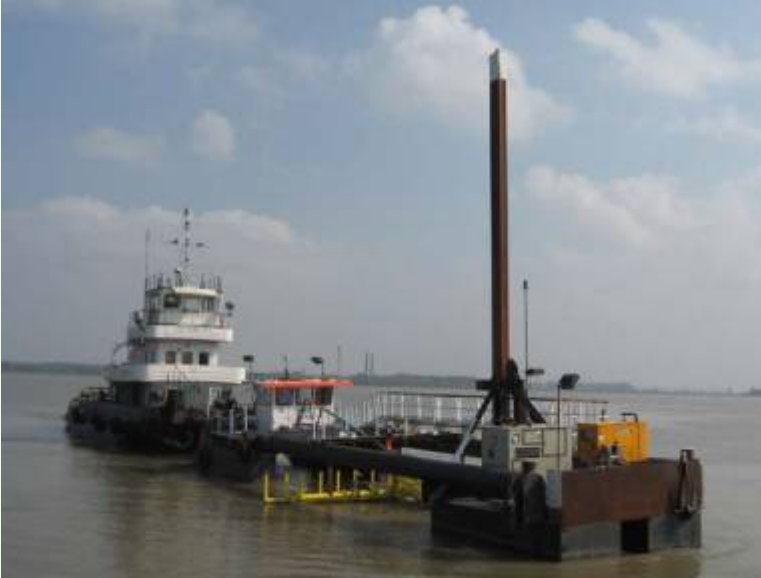
speciaal gebouwd vaartuig voor het detecteren van explosieven
