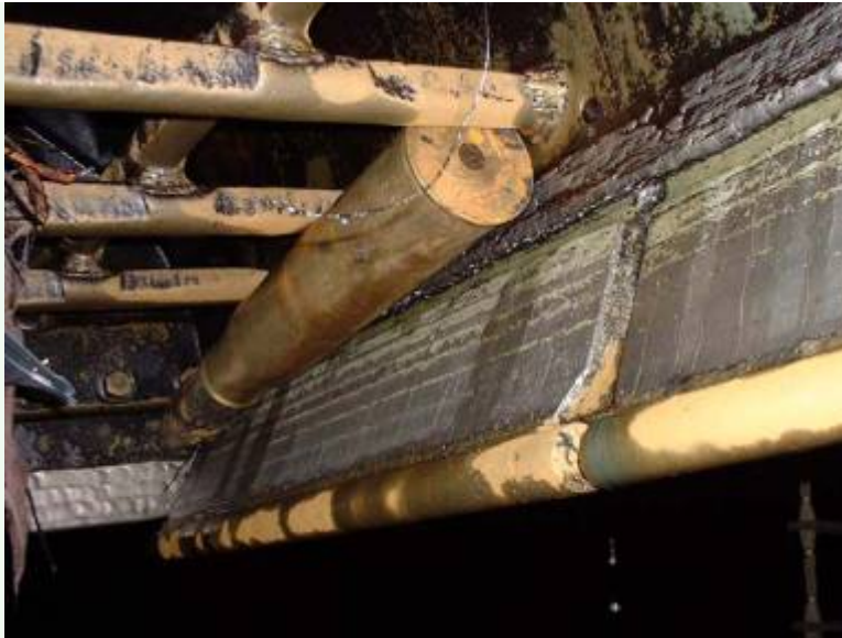
explosief (24cm) aangetroffen in de sleepkop
