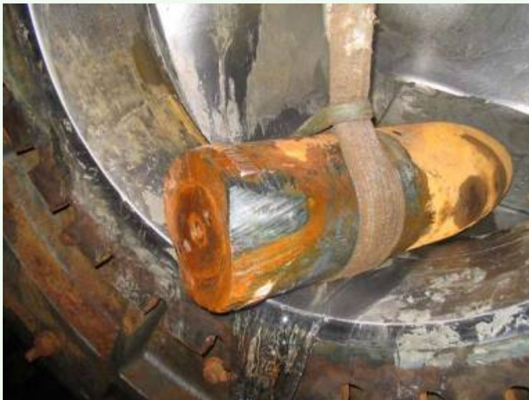
explosief verwijderd uit de waaier
