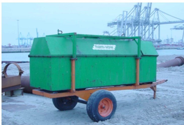
Foto 41 brandstofwagen met dubbelwandige tank.
